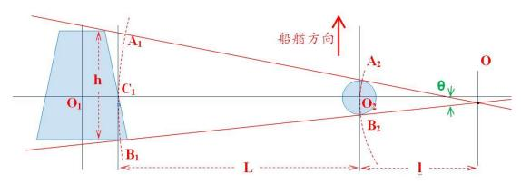
分析:因为 6°的弧度非常小,在这个计算中,我们可以用 h 代替圆心在 O 点、半径为 (L+1) 的圆在梯形桅杆方向的弧长  $A_1C_1B_1$  (L 实际是两个圆弧间的距离。);用圆  $O_2$  的直径 2r 来代替圆心在 O 点、半径为 1 的圆的弧长  $A_2O_2B_2$ 。根据弧度的计算方法,我们有下列近似计算推导:
