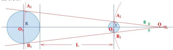
根据上图及前面的分析,我们知道圆弧  $A_1O_1B_1 = 2R$ ; 圆弧  $A_2O_2B_2 = 2r$ ; 根据公式(6)和公式(7),有如下等式:
